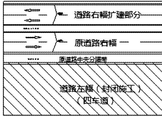
图3 路面施工第三阶段示意图
